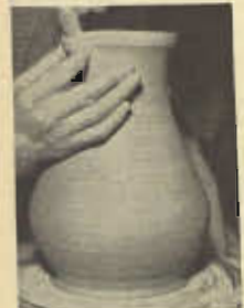
در لبه بالای ظرف بکمک انگشت سبابه دست چپ فرم لوله میگردد
