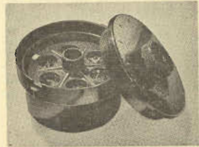
۲ - یکوع دیگر تاك ظهور فیلم ۳۵ میلیتری. گذاشتن فیلم در این تاك حتماً باید در تاریکی انجام گیرد ولی سایر اعمال ظهور متواتر در روشانی باشد.
