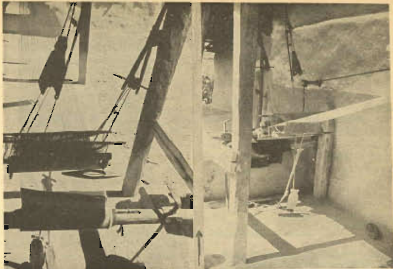
زبان سیامرگونی با این دستگاه که آن را شاه‌گورد - cane gard می‌نامند پارچه‌های نخ‌ریسی می‌بافتند
