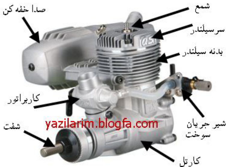
بخشهای مختلف یک موتور دو زمانه
