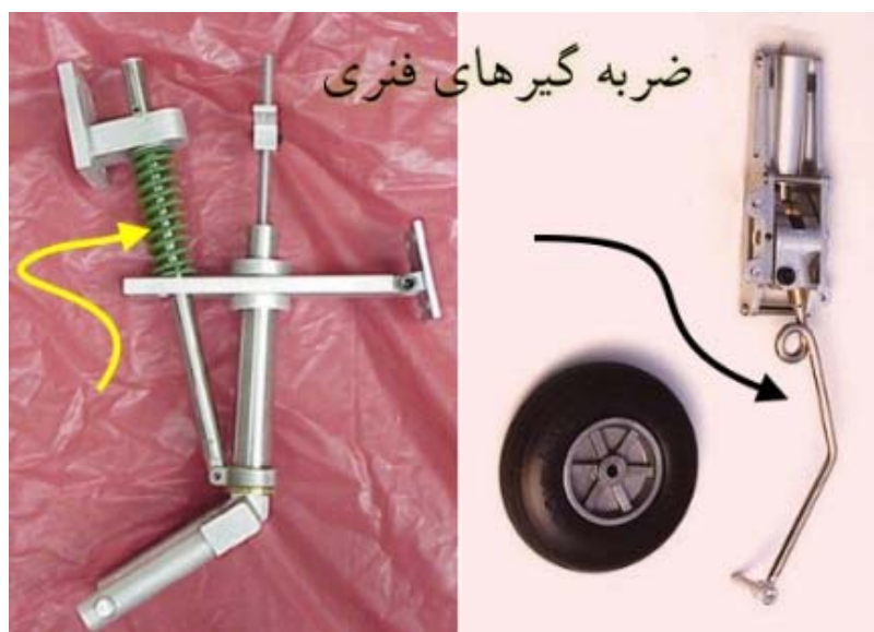
دو نوع ضربه گیر فنری . در سمت راست برای ساده سازی از خود فنر به عنوان بازوی اربابه نیز استفاده شده است .
