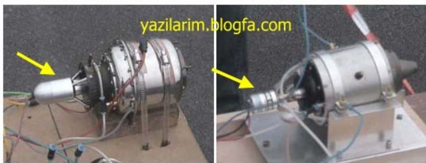
واحد استارت موتور که معمولاً روی دهانه ورودی قرار دارد.
