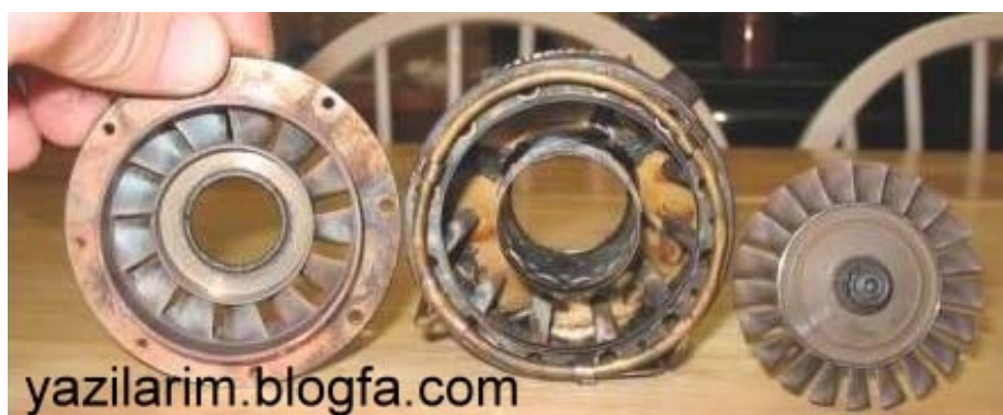
مقایسه یک توربین نو و توربینی که دچار خوردگی شده .
