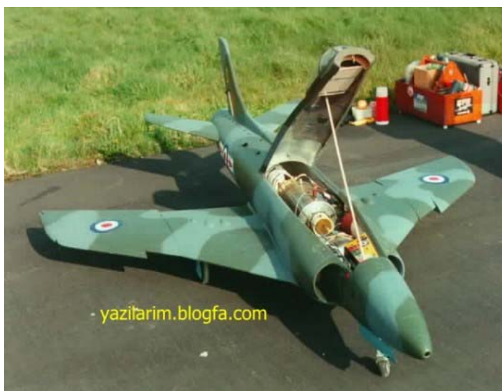
نمونه ایی از نصب موتور در داخل بدنه هواپیمای مدل
