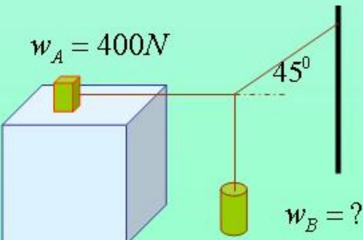
**مثال ۲)** در شکل مقابل وزن جسم  $B$  چقدر باشد تا جسم  $A$  در آستانه لغزش قرار گیرد؟
