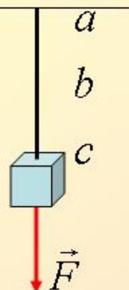
**پرسش :** اگر در شکل زیر نیرو  $\vec{F}$  به دو طریق آنی و به تدریج وارد شود انتظار دارید طناب (همگن) از کدام نقطه پاره شود.
