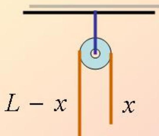
**مسئله :** زنجیری بطول  $L$  قابل انعطافی با توزیع جرم یکنواخت در واحد طول  $\lambda$  از دو طرف یک قرقره بدون اصطکاک وبا جرم قابل صرفنظر آویزان است. در حالیکه طول  $x$  آن از یک طرف قرقره آویزان است شتاب زنجیر را بر حسب  $x$  پیدا گنید.
