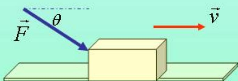
**تمرین ۲)** جسمی به جرم  $m$  در سطح افقی با نیروی که با افق زاویه  $\theta$  می سازد هل داده شده و با سرعت ثابت حرکت می کند. نیروی  $\vec{F}$  را پیدا کنید.  $\mu_s = 0.5 = 2\mu_k$
