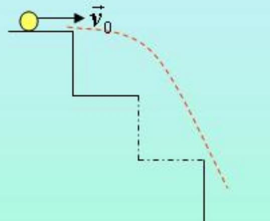
**مثال ۲:** مطابق شکل گلوله ای که با سرعت اولیه ثابت  $۵/۱$  متر بر ثانیه از در سطح افقی پله بالایی یک راه پله حرکت می کند، از لبه آن پُرتاپ می شود. اگر ارتفاع و طول هر پله  $۳۰$  سانتی متر باشد این توپ ابتدا با گدام پله برخورد می کند.
